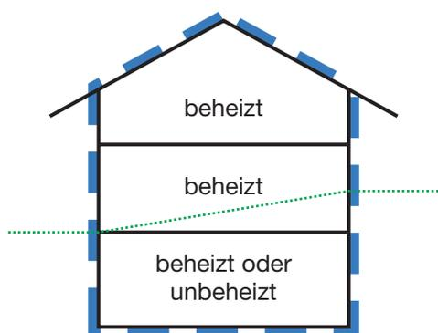
Wenn das gesamte Untergeschoss innerhalb der thermischen Gebäudehülle liegt, die Wärmdämmung von Aussenwand und Dach bei keinem Anschluss durchdrungen und das Fenster an der Kante der Wärmedämmung angeschlagen wird (vgl. Detail), gilt der Wärmebrückennachweis als erfüllt.
